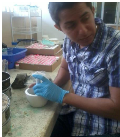
Figura 3.9. Molienda de las muestras.
