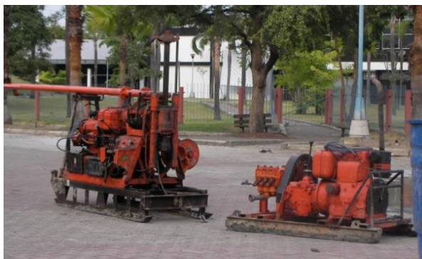
Figura 3.2. Sonda ACKER TP 30 sobre patines.
