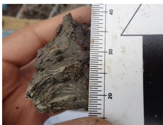
Figura 4.63. Limo con intercapas de arena.
