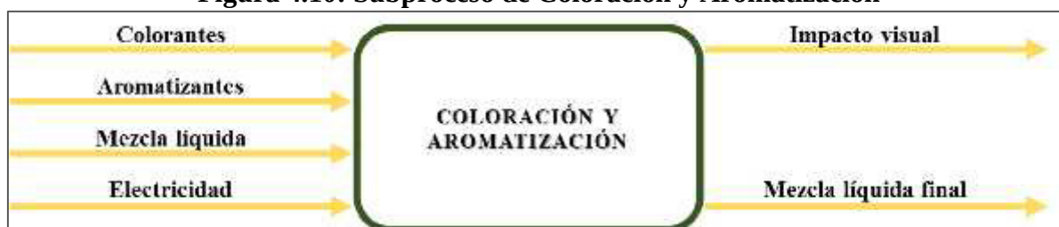
Figura 4.10: Subproceso de Coloración y Aromatización
