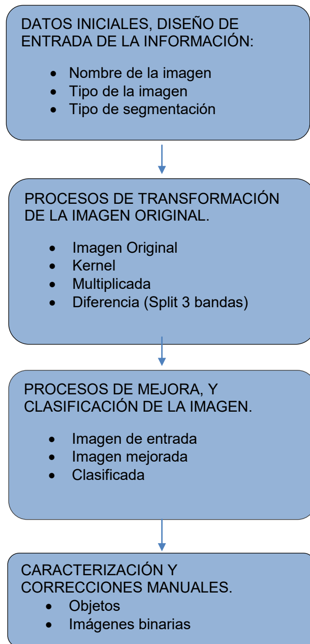
Figura 49. Esquema general de la macros con la secuencia completa del tratamiento de la Imagen.
