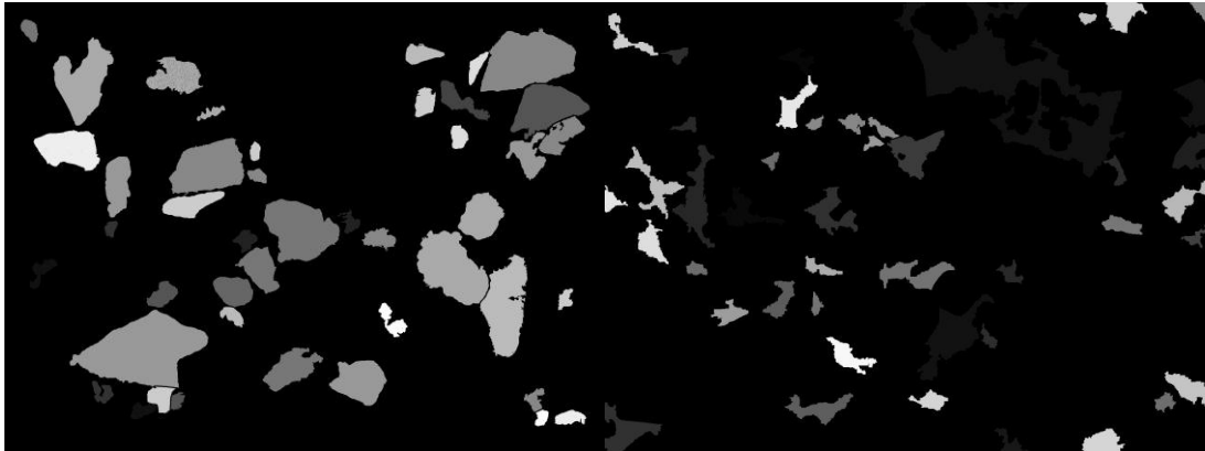
Figura 68. Bin producto de la segmentación de cuarzos (lqz.) y de poros (der.) de una escena de la muestra SI_9.
