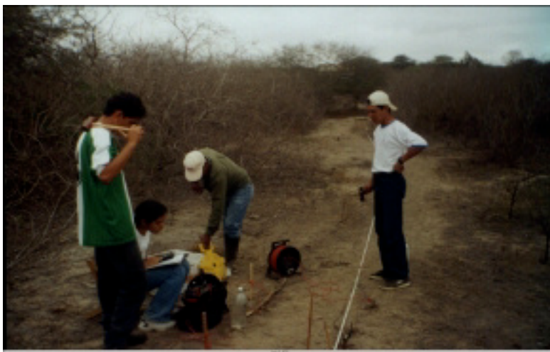
Foto 15. Realización de la Prospección Geoeléctrica.
