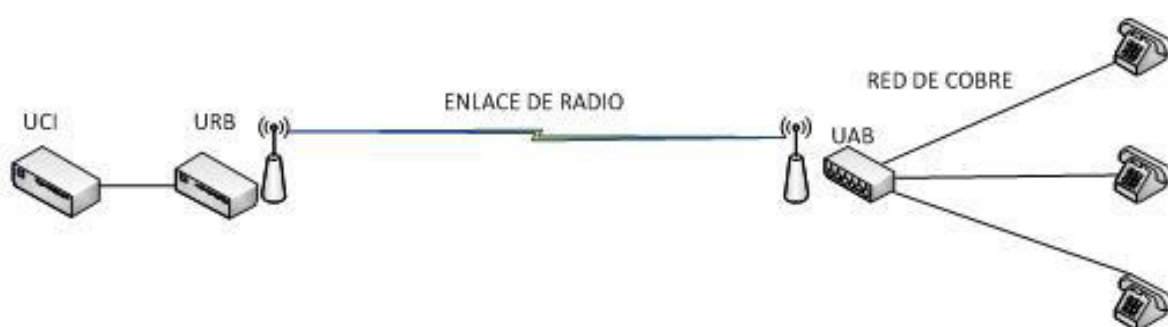
Figura 10. Esquema de una red SMD-30
