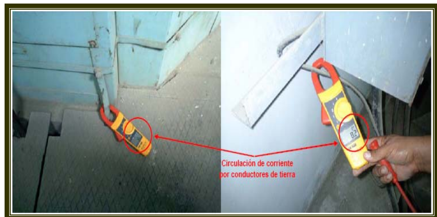
Figura 2.16 Circulación de corrientes por conductores a tierra
