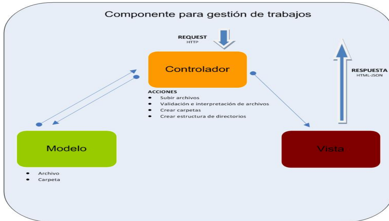
Figura C.1.2 Componente para la gestión de trabajos
