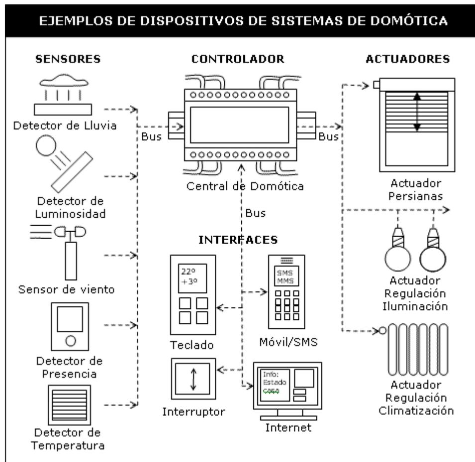
Figura 1-3 Ejemplos de dispositivos de sistemas de domótica
