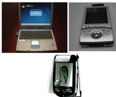
Figura 2-6 Equipos Mesh Clients.
