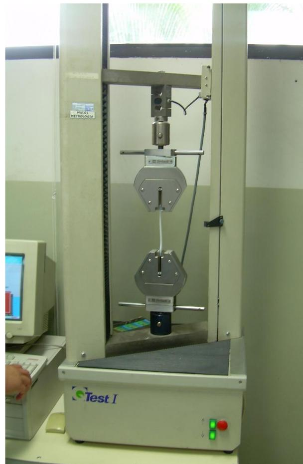
Figura 2.10 Tensómetro Qtest.
