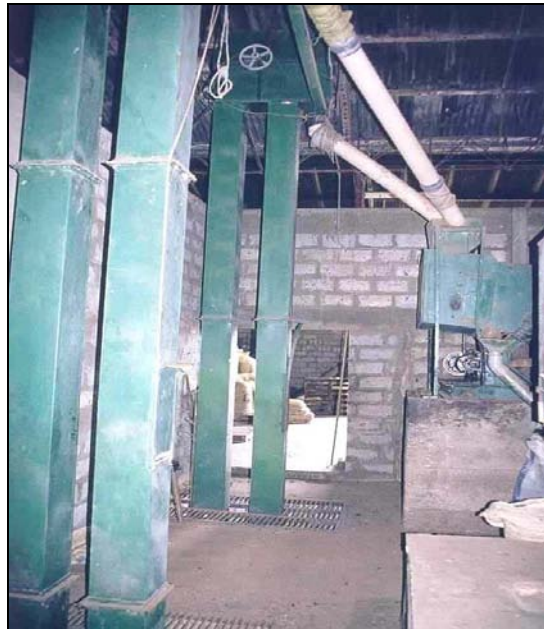
Figura No. 23. Cilos de Transporte de Cacao
