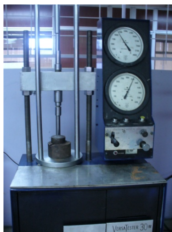
FIGURA 3.1 MÁQUINA DE ENSAYOS DE TRACCIÓN VERSATESTER
