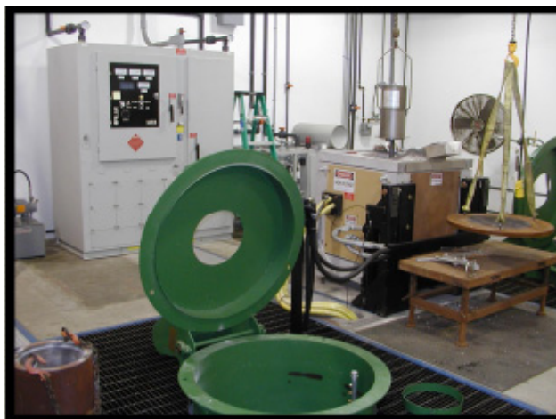
FIGURA 1.10 INSTALACIÓN TÍPICA DE UNA MÁQUINA CENTRIFUGADORA VERTICAL
