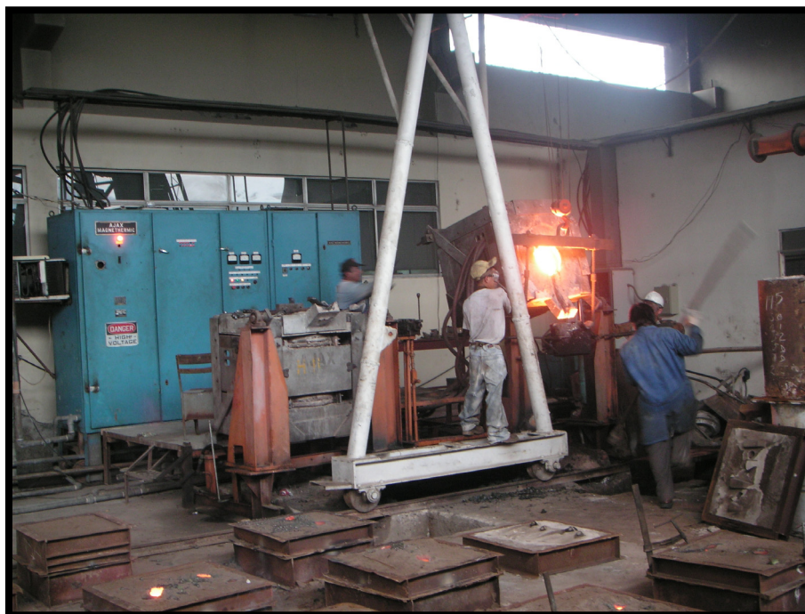
FIGURA 1.1 FUSIÓN EN HORNO DE INDUCCIÓN, ELABORACIÓN DE ALEACIONES FERROSAS Y ACEROS.
