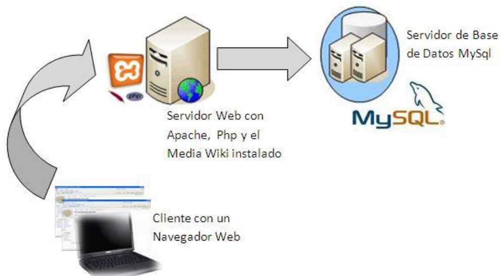
Figura 14. Arquitectura final del sistema
