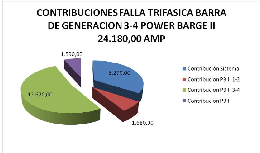
**Figura 3 VII Contribuciones falla trifásica Power Barge II**
