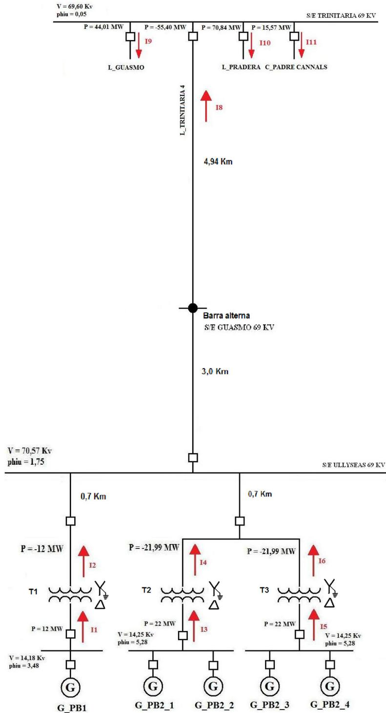
Figura 2 I Flujo de potencia del sistema eléctrico
