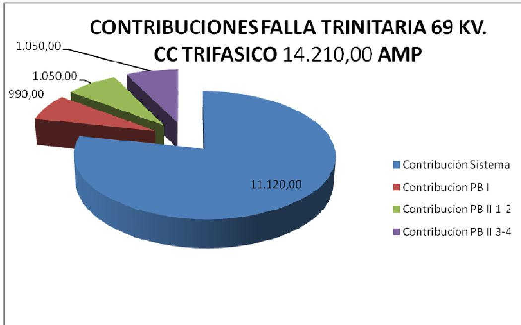
Figura 3 I Contribuciones falla trifásica trinitaria 69 KV
