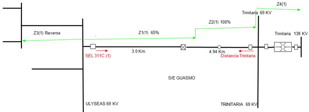
Figura 4 V Diagrama de tiempo protección Distancia
