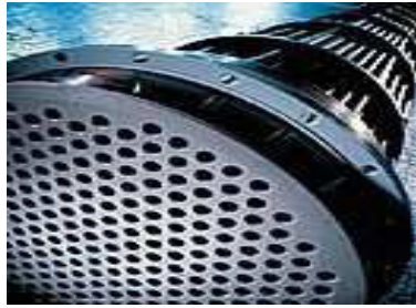
Figura 3.4 Intercambiador De Tubo
