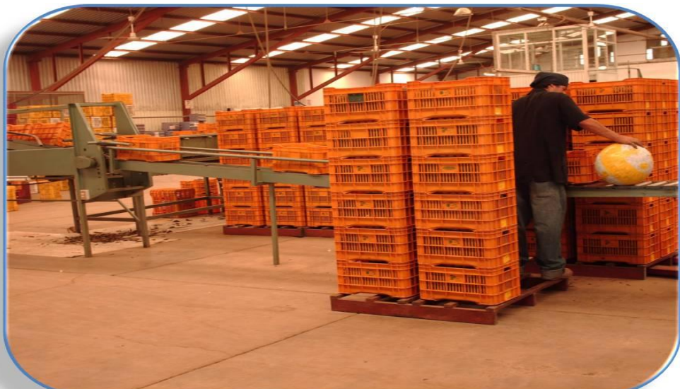
Imagen 6: Máquina volteadora de cajas
