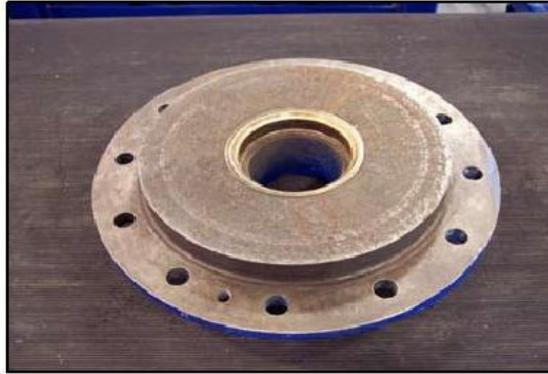
Figura 4-12. Anillos de desgaste para impulsores cerrados
