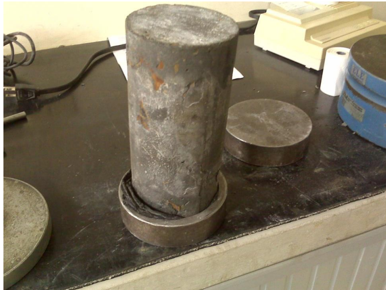
FIGURA 29. Cilindro de HAD ensayado a la compresión simple a los 21 días
