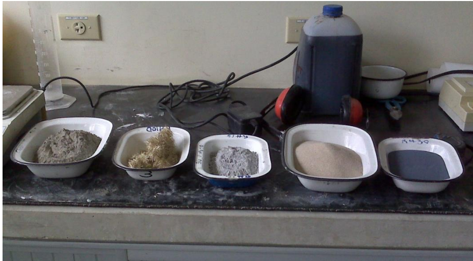
FIGURA 4. Componentes del Hormigón de Ultra Alto Desempeño. De izquierda a derecha: Cemento tipo I, fibra metálica, polvo reactivo, arena silicia y humo de sílice. Detrás: Superplastificante.
