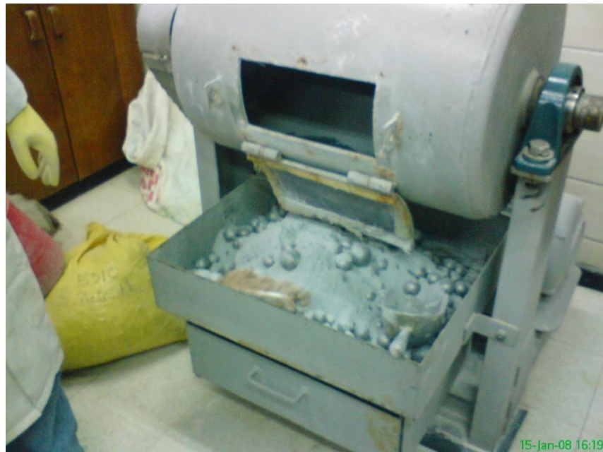
FIGURA 27. Obtención del polvo reactivo producto de la molienda de la arena cuarzosa.
