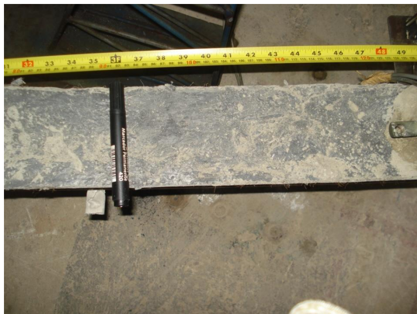
FIGURA 36. Detalle ubicación de fisura en la zona de falla de la viga construida con HAD (vista posterior).
