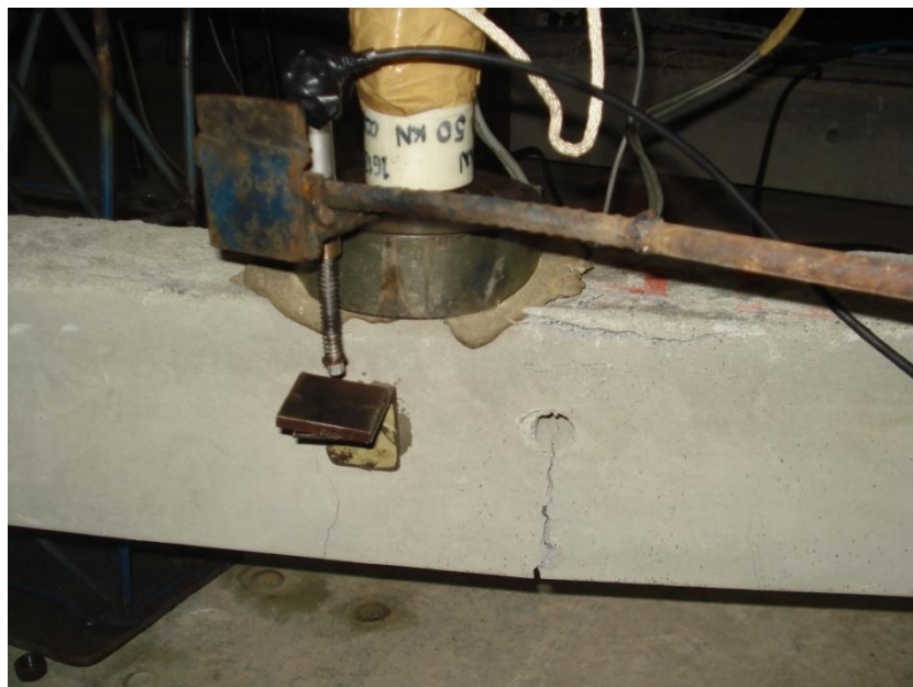
FIGURA 34. Detalle de fisura en la zona de falla de la viga construida con hormigón convencional (vista posterior).
