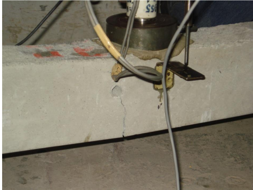
FIGURA 34. Detalle de fisura en la zona de falla de la viga construida con hormigón convencional (vista posterior).
