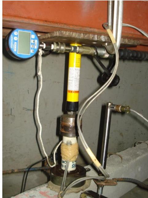
Una vez montada la instrumentación, calibrado y encerado el equipo se procedió a comenzar con la prueba de carga primero con la viga construida con hormigón convencional, se le iba agregando carga y se almacenaban los incrementos de carga y deflexión en intervalos de 1 segundo, el archivo de datos generado de las pruebas se pueden ver en el Anexo 6, los gráficos Carga versus Deflexión de cada uno de los ensayos se muestra a continuación, las tablas generadas se encuentran en el Anexo A.
