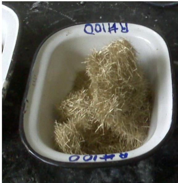
**FIGURA 28.** Fibra metálica Bekaert OL13 0.16.
