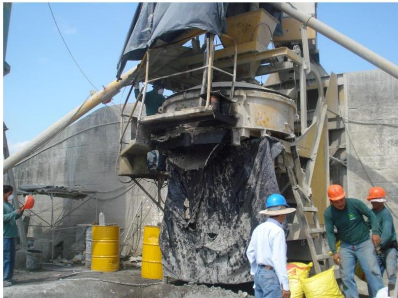
**FIGURA 22.** Dosificadora – Mezcladora. Capacidad aproximada  $0.25$  metros cubicos.
