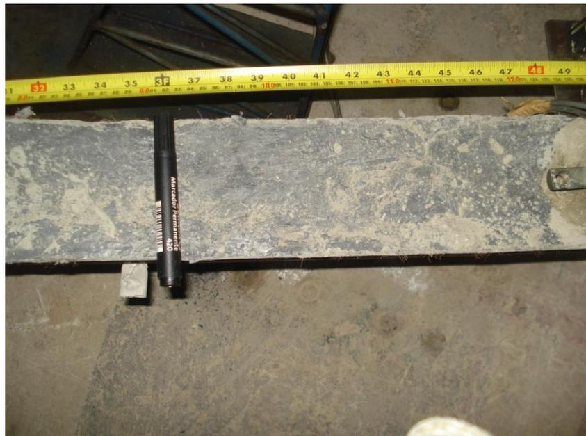
**FIGURA 37.** Detalle de fisura en la zona de falla de la viga construida con HAD (vista posterior).
