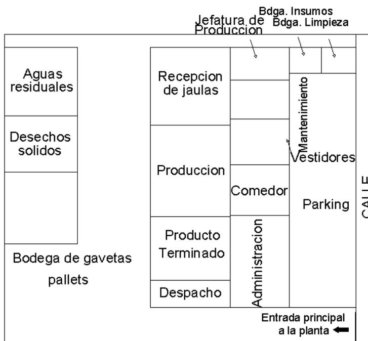
**FIGURA 4.6. Alternativa 3 para la elección del Block Layout final.**
