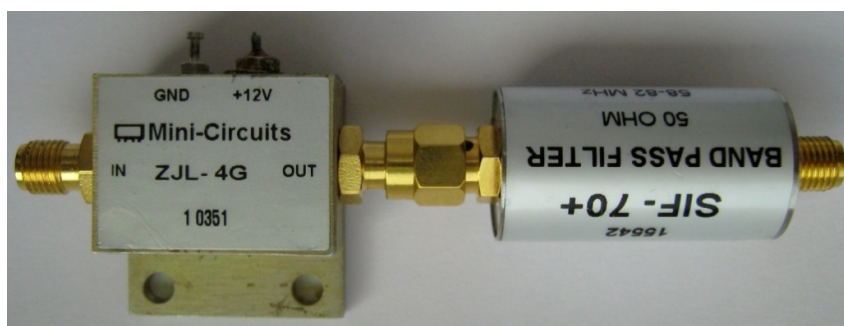
Figura 5.7 Segunda Etapa trasmisora: Filtraje.
