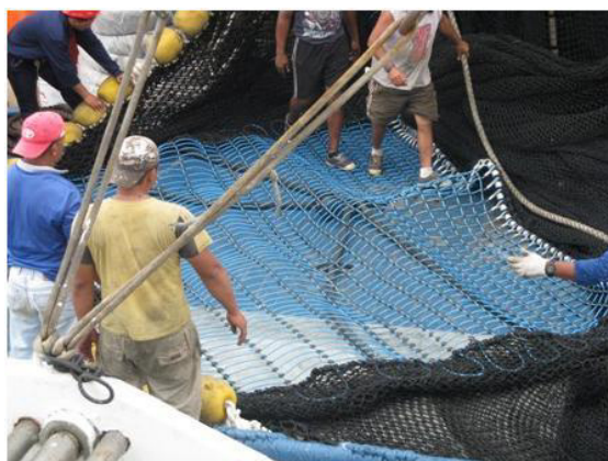
GRÁFICO 1.3: Mecanismo de rejilla para la extracción de túnidos
