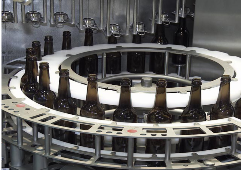
FIGURA 3.13. BOTELLAS INGRESANDO A MÁQUINA LLENADORA.
