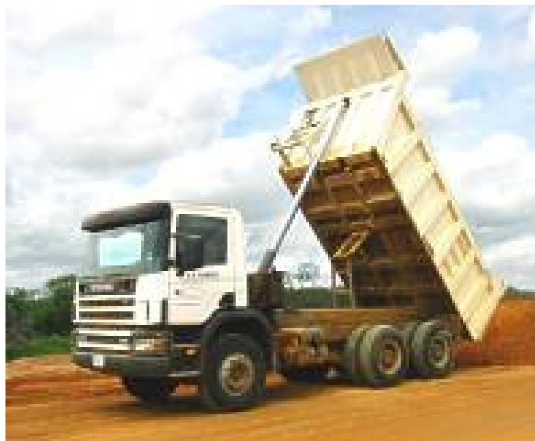
Estoqueo de material por volquetas
