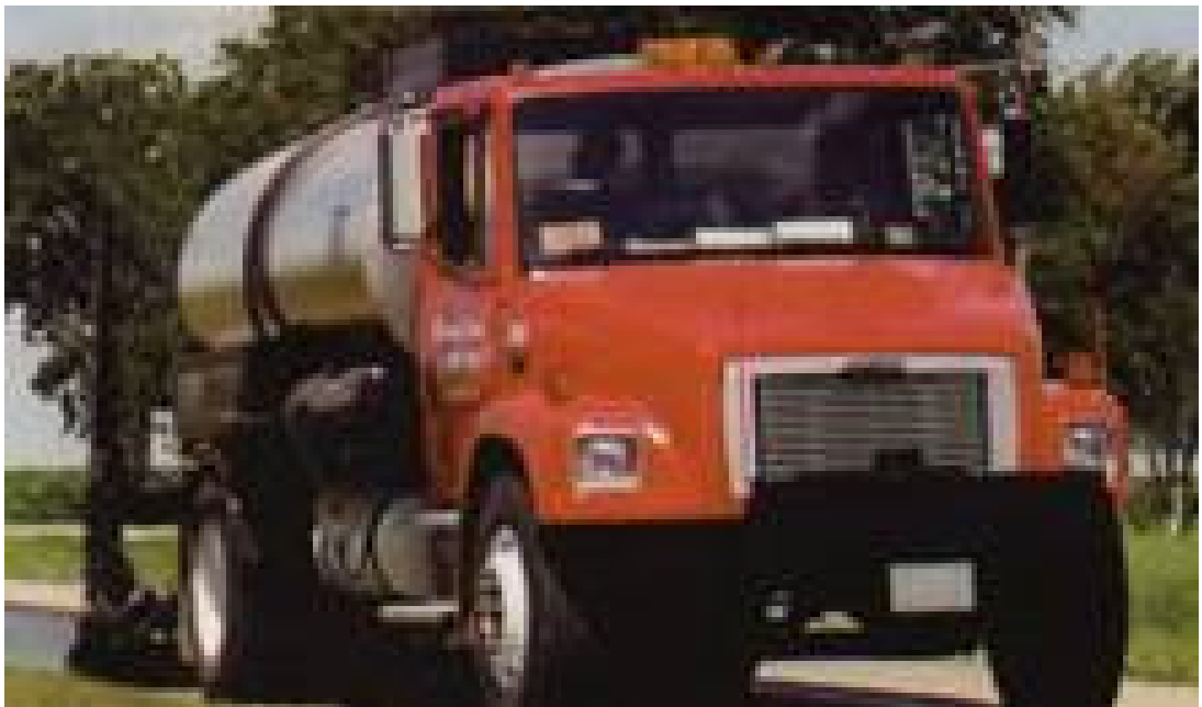
Imprimación con tanquero esparcidor
