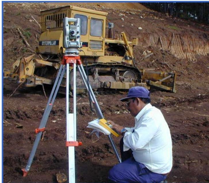
Fig. 3.6 Control in situ de cotas de subrasante
