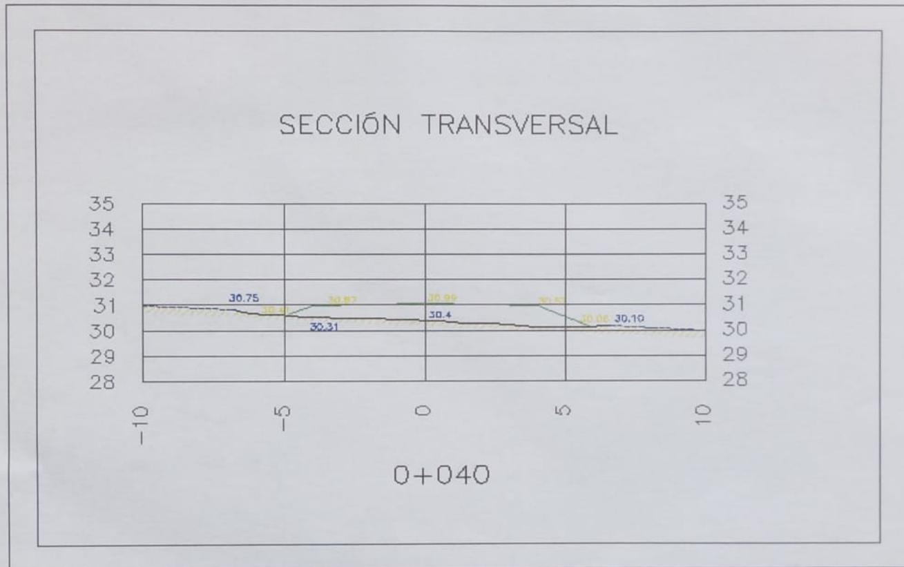
**Fig. 3.2** Secciones transversales de relleno
