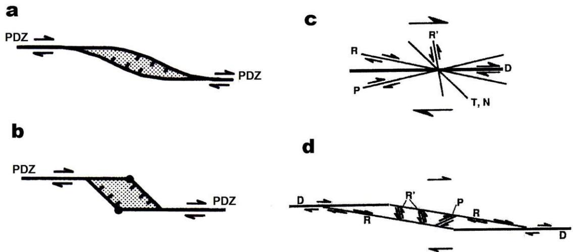
Figura 5.7. Formación de cuencas de pull-apart: a) a partir de una falla simple de desplazamiento de rumbo, b) a partir de dos fallas en échelon. c) orientación y d) distribución de las estructuras asociadas (modificado de Rahe et al., 1998; y Sims et al., 1999).
