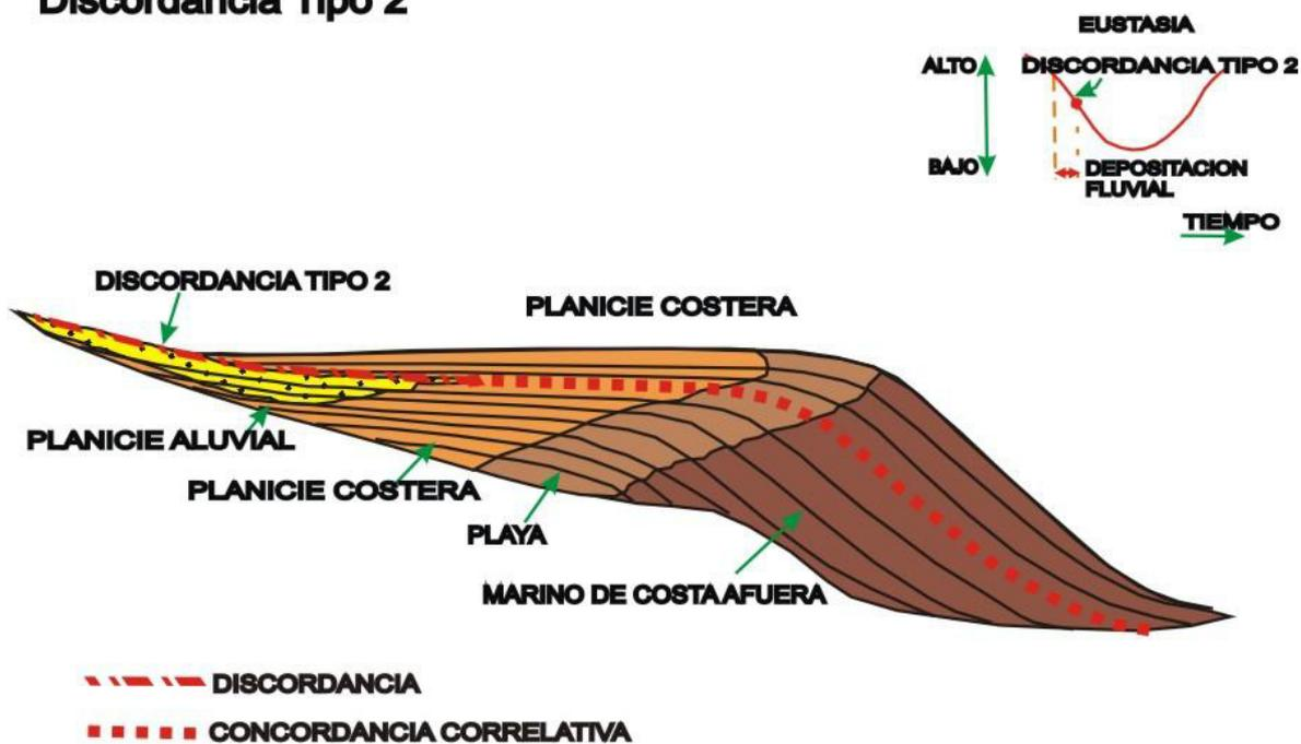
Figura 1.7. Tipos de discordancias en una secuencia silicoclástica, tomado de Posamentier et. al. (1988).
