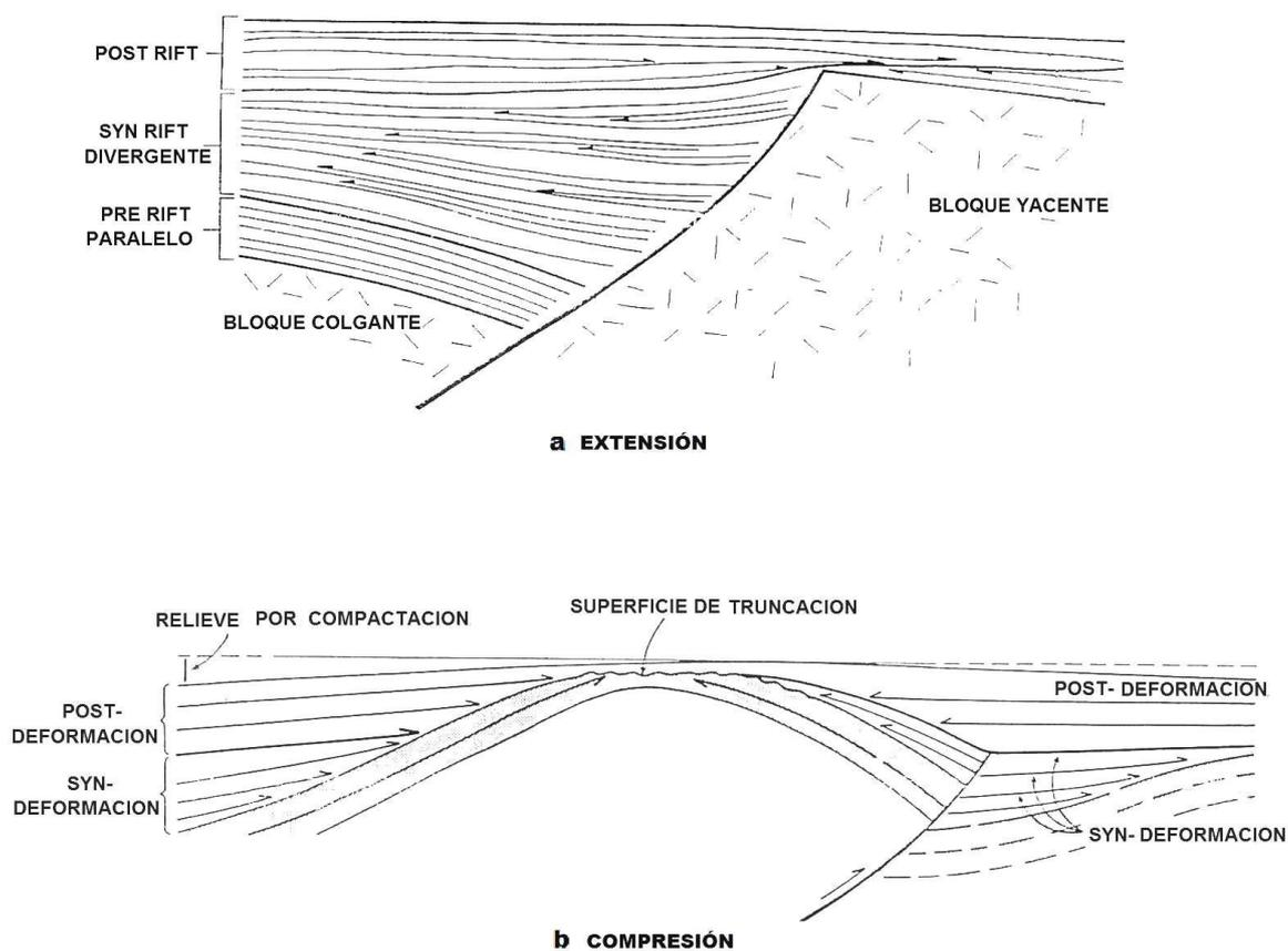
**Figura 5.4.** Configuraciones pre, syn y post deformativas en a) extensión y b) compresión (modificado de Cartwright J.A., 1992).
