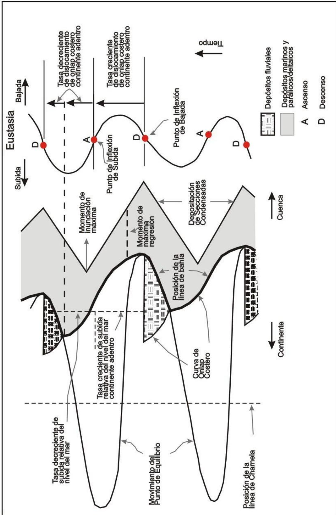
Figura 1.8. Elementos de la Curva de Desplacamiento del Onlap Costero (modificado de Posamentier et al., 1988).
