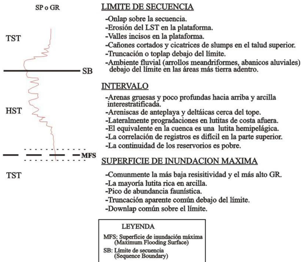
Figura 3.1e. Respuesta del registro SP y/o GR para el sistema de mar alto, modificado de Vail y Wornardt, 1991.
