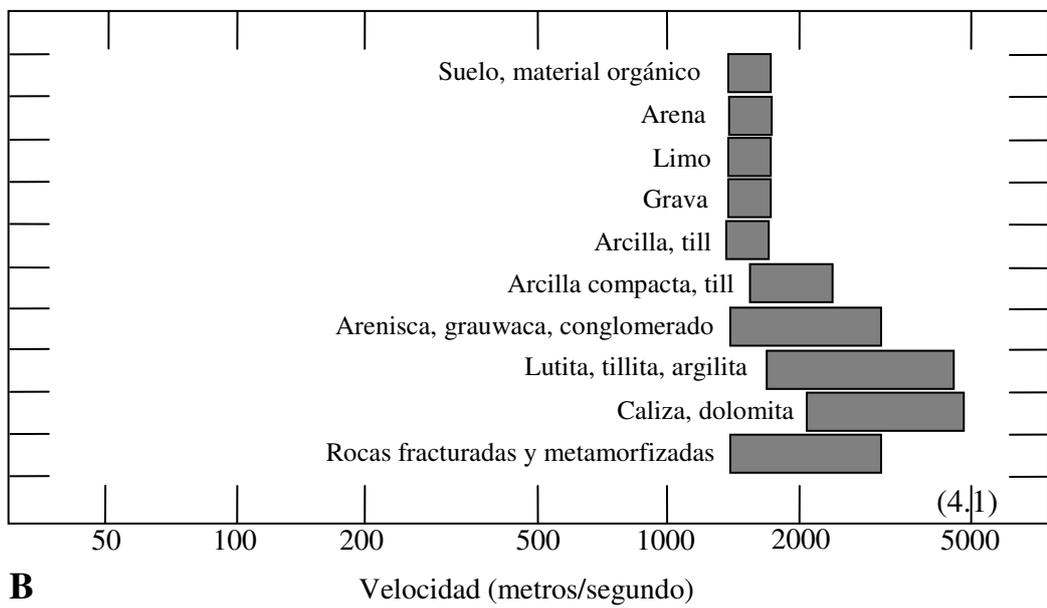
**Figura 4.1. Rangos típicos de velocidades sísmicas para rocas y depósitos superficiales (según Todd, 1980). A.Materiales no saturados. B.Materiales saturados.**
