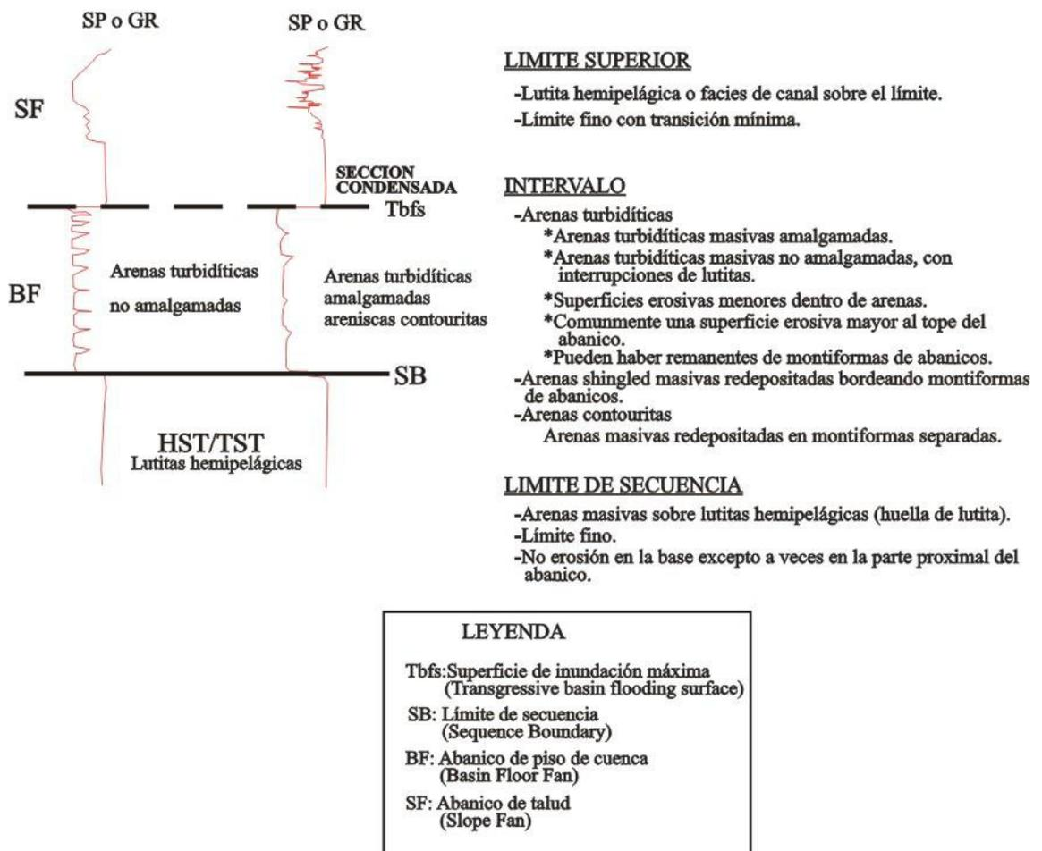
Figura 3.1a. Respuesta del registro SP y/o GR para el sistema de mar bajo - abanico de piso de cuenca, modificado de Vail y Wornardt, 1991.
