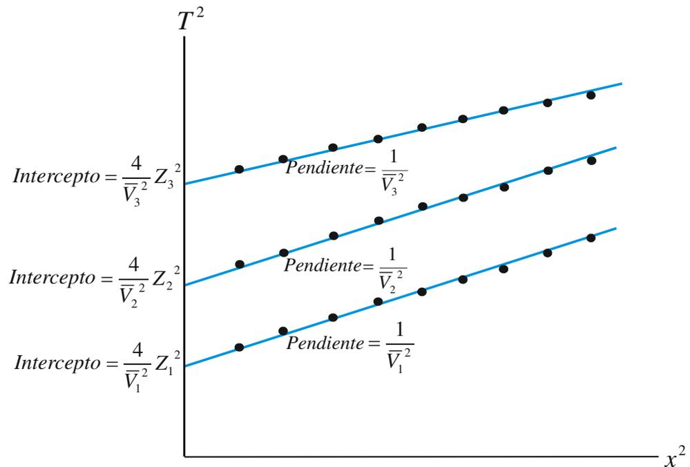
**Figura 4.4.** Determinación de  $\bar{V}$  de tres horizontes por análisis de reflexiones.
