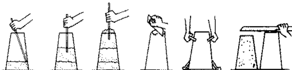
Fig. 4.11 Ensayo de asentamientos del cono de Abrams.
