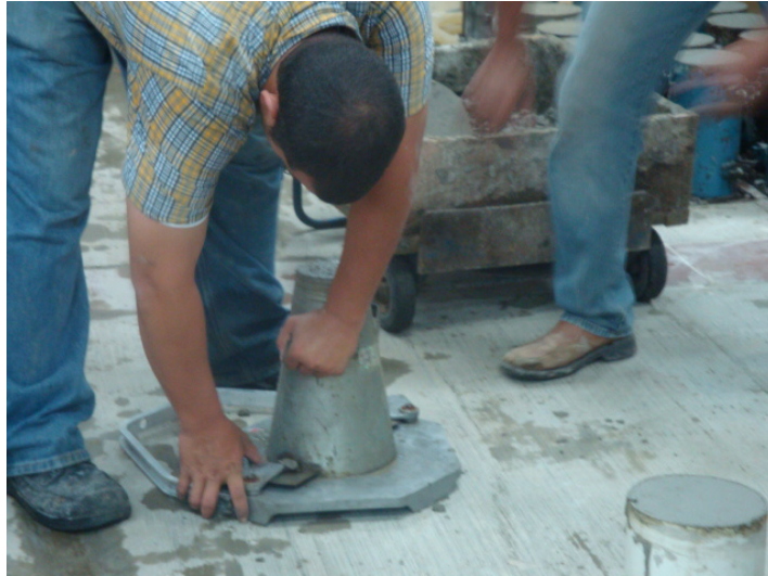
EXTRACCION DEL CONO DE ABRAMS
