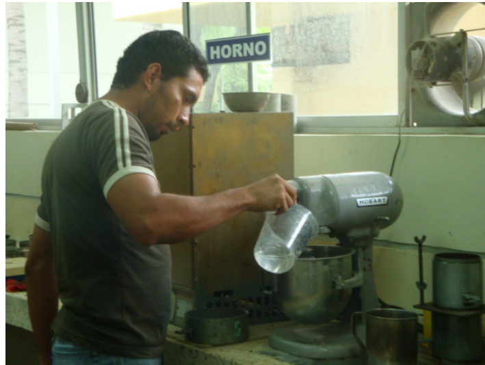
MEZCLADO DEL MORTERO CEMENTO ARENA
