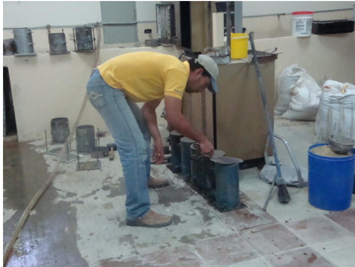
RASADO DEL HORMIGON
