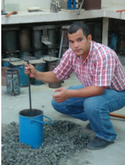
VARILLADO DEL AGREGADO GRUESO
