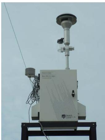
El segundo gran grupo para medir la concentración de material particulado son los equipos que utilizan el principio de la dispersión de luz para calcular la concentración de material particulado. Estos equipos utilizan diferentes impactadores para poder medir PM10 o PM2.5, utilizan un sensor óptico para detectar y medir el material particulado en concentraciones de hasta 100 miligramos por metro
