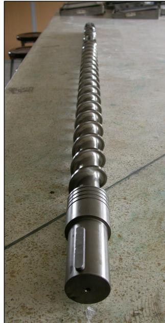
**FIGURA 3.4 TORNILLO EXTRUSOR**
