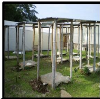
Camas de Lixiviados.
