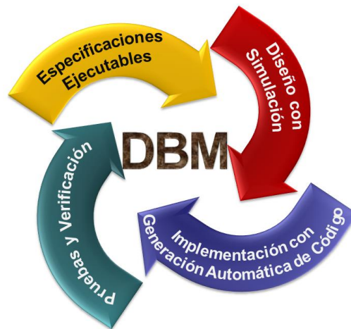
Figura 3.1: Relación entre las distintas fases del Diseño Basado en Modelo
