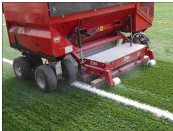
Figura N° 2.39 Riego de arena y caucho
