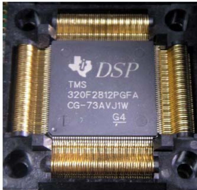
Figura 4.3 Vista externa del DSP TMS320f2812
