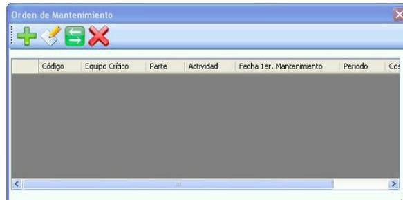
Al **ingresar una nueva orden de mantenimiento** aparece un cuadro de diálogo con diferentes campos a completar entre los cuales se encuentran: equipo crítico, parte del equipo, ubicación del equipo, actividad, período, fecha del primer mantenimiento, repuestos; y costo planificado.
