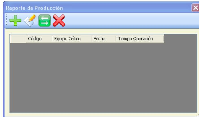
Para **ingresar un nuevo reporte de producción** se debe presionar el botón “Ingresar”. Automáticamente se abre una nueva ventana con los siguientes campos para completar: equipo crítico, fecha del reporte, tiempo de operación, calidad esperada, calidad real, rendimiento esperado y rendimiento real.
