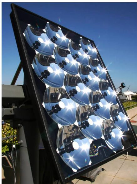
Figura 3.28. Sistema de captación por espejos
