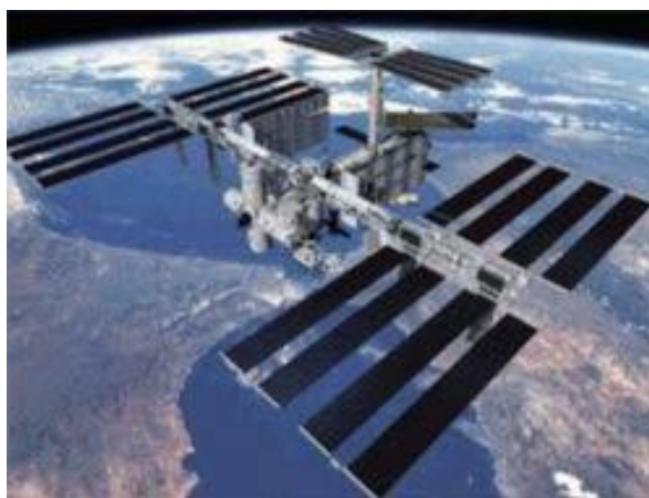
Figura 2.2. Instalación Fotovoltaica en Satélites
