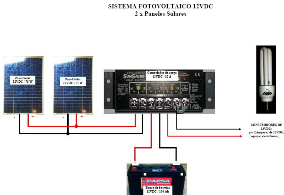
Figura 4.7. Sistema de Generación Fotovoltaica de 400Wh/día
