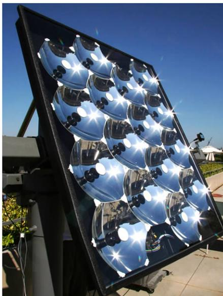
Figura 3.28. Sistema de captación por espejos
