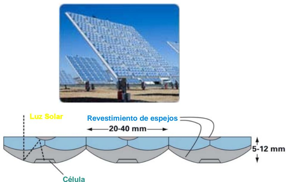
Figura 3.27. Sistema de captación y dirección de luz
