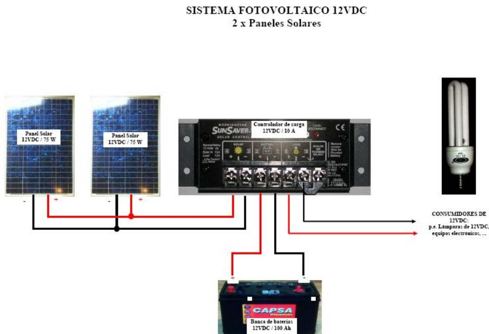
Figura 4.7. Sistema de Generación Fotovoltaica de 400Wh/día
