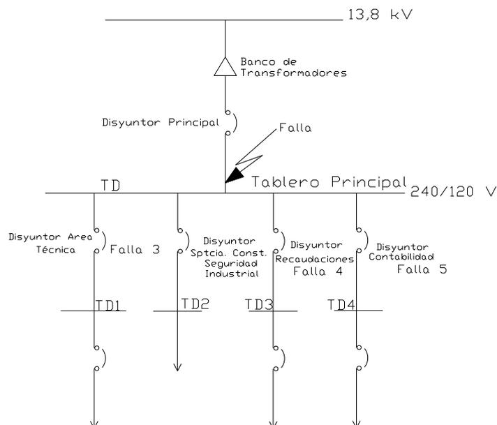
**Figura 4.1 Punto de falla en red de Baja Tensión**
