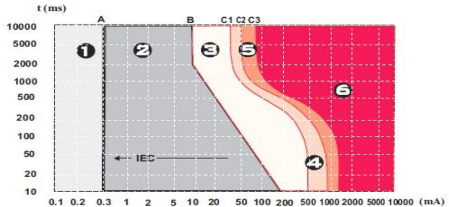
**Figura 1.3 Zonas de tiempo/corriente de los efectos de las corrientes alternas de 15 a 100 Hz**
