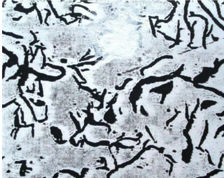
FIGURA 2.4 MICROESTRUCTURA 2 TOMADA A PROBETA DE TRACCIÓN AL MARCO 2
