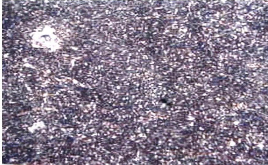
FIGURA 2.7 MICROESTRUCTURA 5 TOMADA AL SOPORTE GRANDE DE CHAPA SOLDADA COMPUESTA POR FERRITA Y PERLITA
