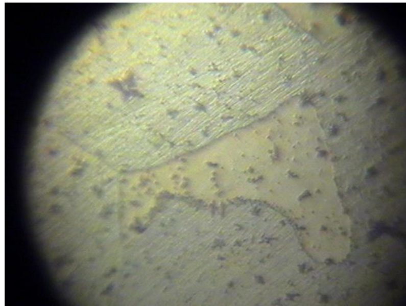
FIGURA 2.20. (160X) METALOGRAFÍA DE MUESTRA 3. FUNDICIÓN EN ARENA. REACTIVO: 2 GR. K_2CR_2O_7 , 8 ML H_2SO_4 , 4 ML NACL (SOLUCIÓN SATURADA), 100 ML H_2O
