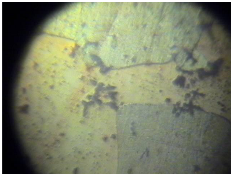
FIGURA 2.24. (160X) METALOGRAFÍA DE MUESTRA 7. FUNDICIÓN EN ARENA. REACTIVO: 2 GR. K_2CR_2O_7 , 8 ML H_2SO_4 , 4 ML NACL (SOLUCIÓN SATURADA), 100 ML H_2O
