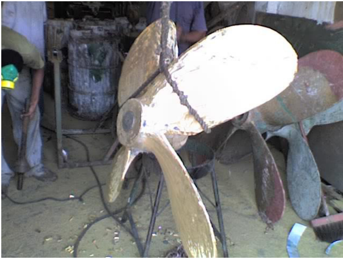
FIGURA 2.31. HÉLICE EN PROCESO DE MAQUINADO PARA DAR EL BALANCEO ESTÁTICO
