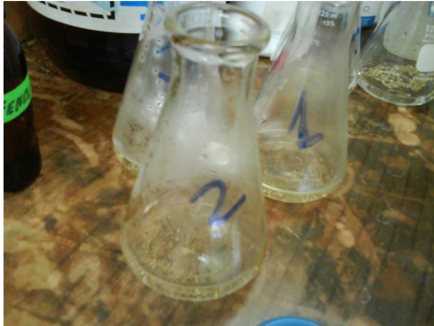
FIGURA 2.14. VIRUTA DE MUESTRAS DE BRONCE EN SOLUCIÓN DE ÁCIDO NÍTRICO Y ACIDO CLORHÍDRICO CONCENTRADO
