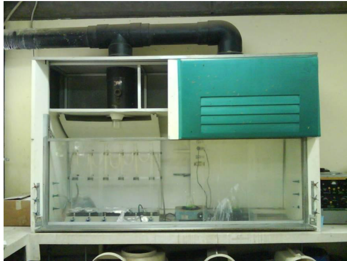
FIGURA 2.15. MUESTRAS EN SORBONA PARA SU DISOLUCIÓN
