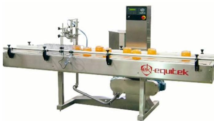
La serie DW-L está enfocada para producciones de 200 a 2000 litros por hora de productos de alta viscosidad con la posibilidad de manejo de sólidos en suspensión de hasta 3 cm, dependiendo del tamaño de la bomba volumétrica, es un equipo automático sencillo y versátil con facilidad para cambios de formato de envases.
