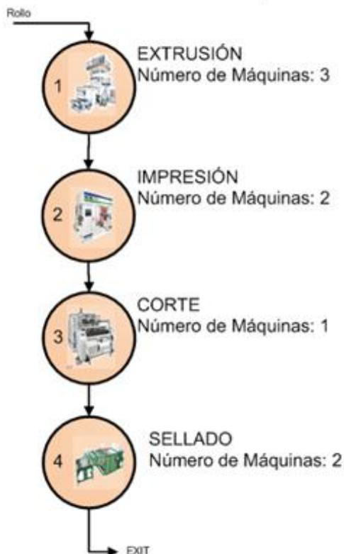
FIGURA 10. Diagrama de proceso de la elaboración de fundas impresas
