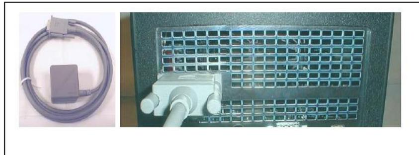
**Figura 2.7 Conexión de la fuente magnética [16]**
