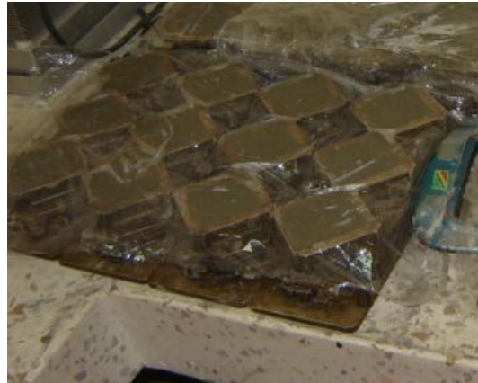
FIGURA 3.2. ALMACENAMIENTO DE MOLDES CON LA MEZCLA
