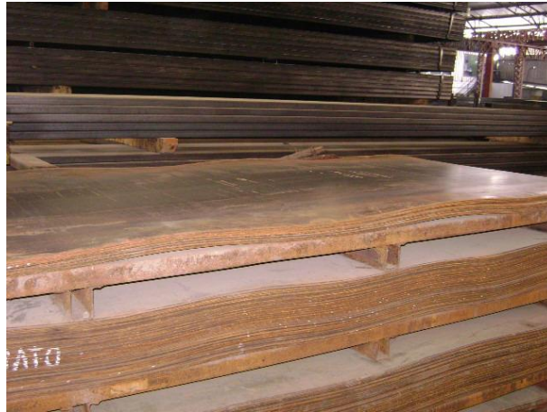
FIGURA 1.21 CHAPAS CON ONDULACIONES SUPERFICIALES
