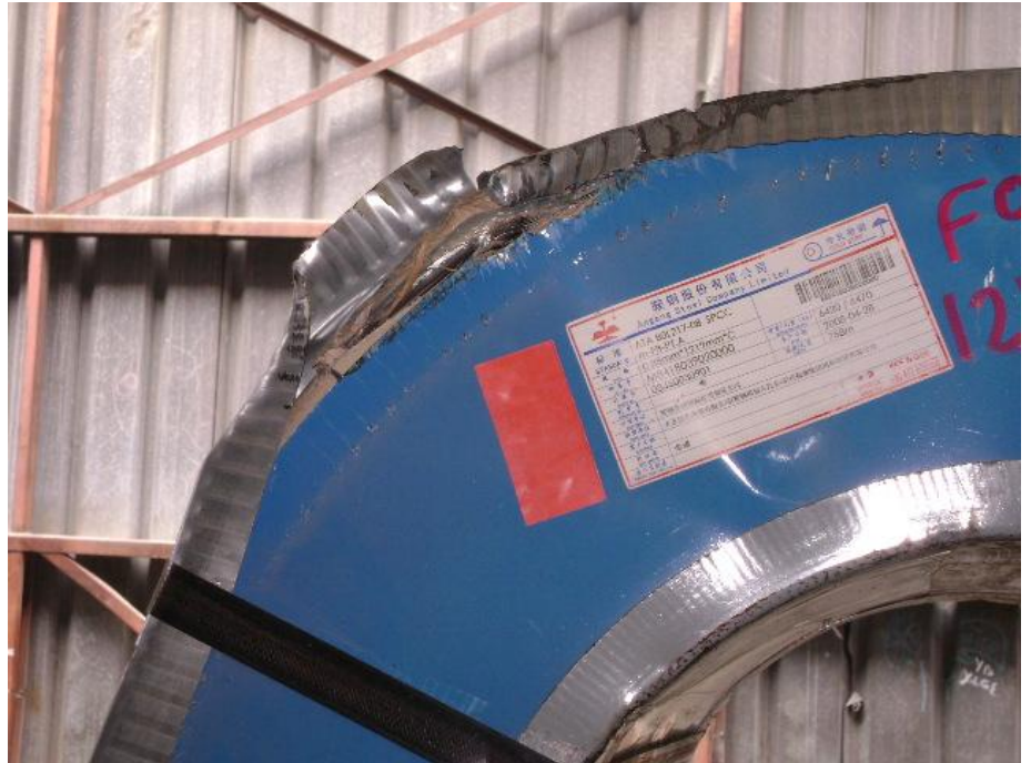
FIGURA 1.14 PROTECCIÓN DE BOBINA DAÑADA
