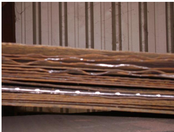
FIGURA 1.23 CHAPAS CON BORDES ONDULADOS
