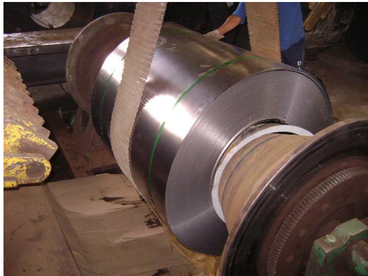
FIGURA 1.29 BOBINA EN FASE DE MONTAJE EN DESENROLLADOR
