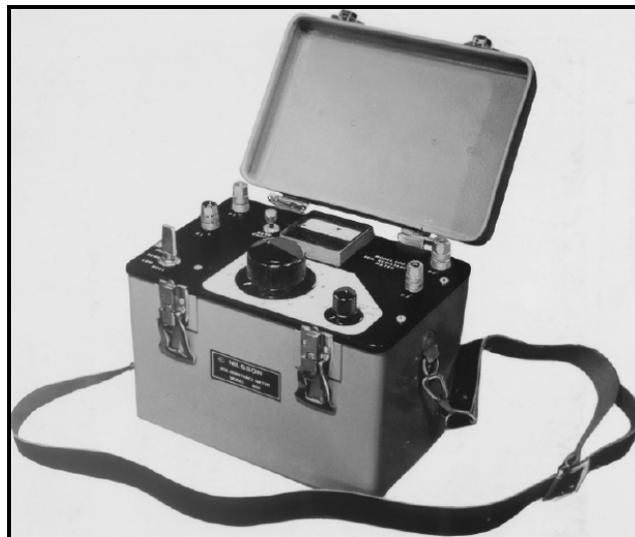
**FIGURA 2.6 MEDIDOR DE RESISTIVIDAD MARCA NILSSON
