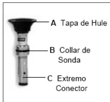
**FIGURA 3.14: SONDA DE PRESIÓN ESTÁTICA.**
