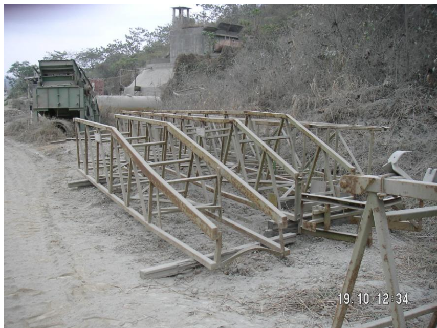
FIGURA 4.1. ARMADURA DE TRANSPORTADORES
