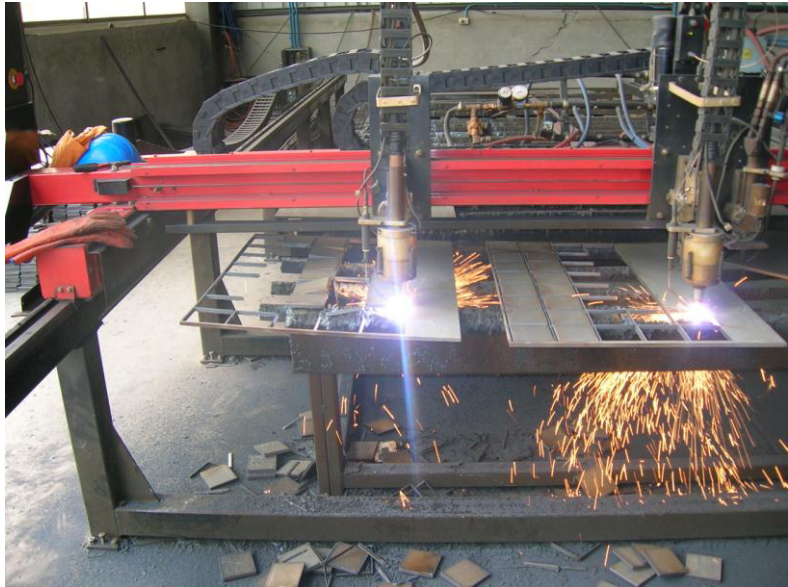
FIG. 2.6 PANTOGRAFO (Cortesía Intermetal)
