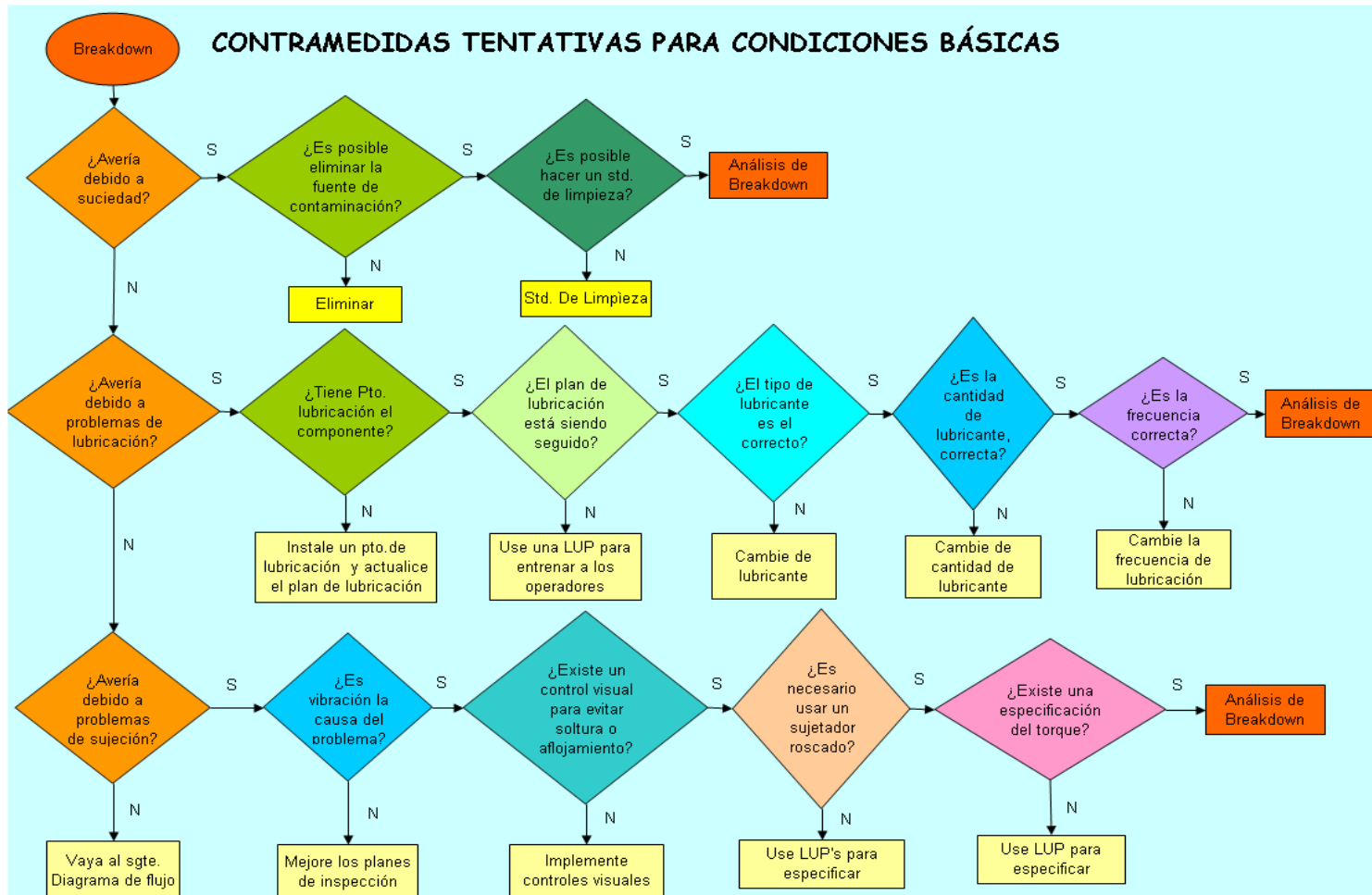
FIGURA 3.6: FLUJO PARA LA CONTRAMEDIDA CONDICIONES BÁSICAS
