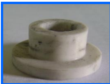
FIGURA 3.21: BOCÍN CON MATERIAL DE TEFLÓN
