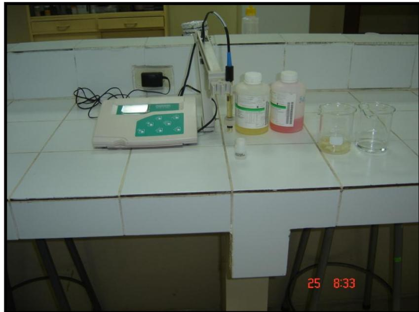
**FIGURA 2.5. pHMETRO UTILIZADO EN ANÁLISIS FÍSICO – QUÍMICO DEL PAN PREOCOCIDO.**
